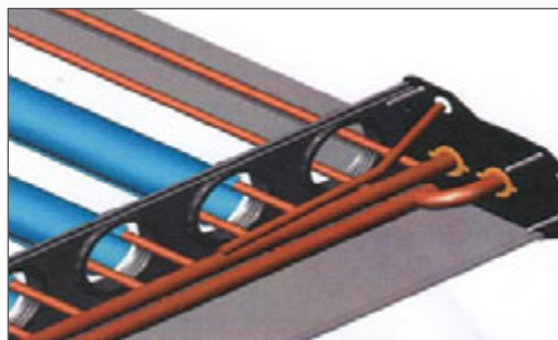
Technischer Schnitt Diffustar-Module
