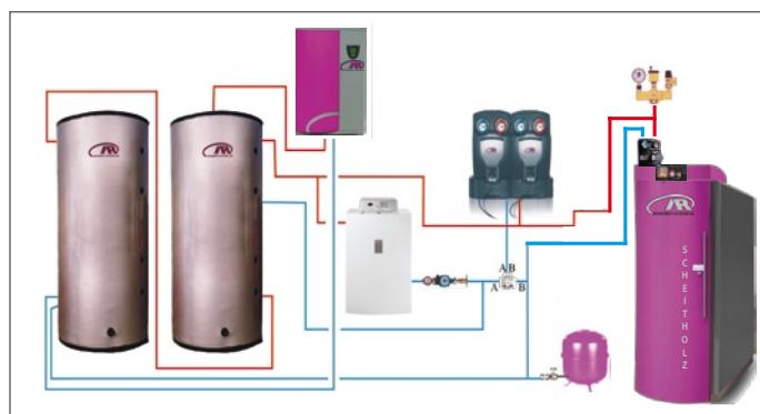
Scheitholzkessel mit Großflächenkollektor, Frischwasserstation und zwei gemischten Heizkreisen
