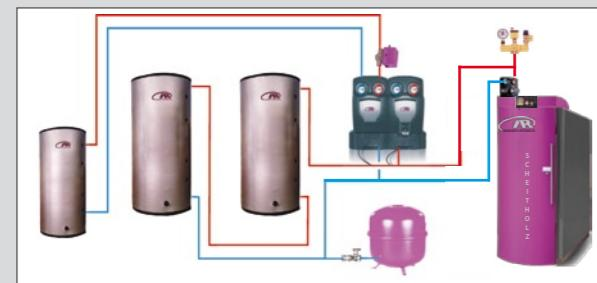
Scheitholzkessel mit Frischwasserstation und einem gemischten Heizkreis
